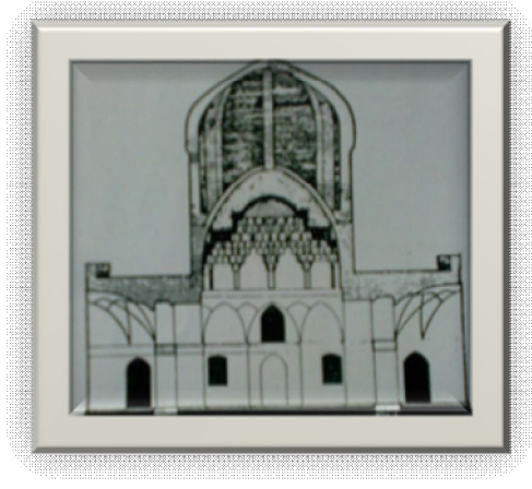
نمونه کاملی از سه پوسته مجزا در زیر گنبد (امامزاده اسماعیل-قزوین) نمونه کاملی از سه پوسته مجزا در زیر گنبد (ملاحسن کاشی)
